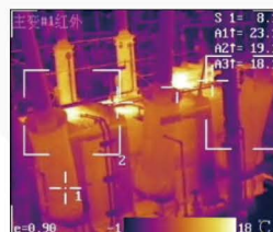
变压器接头过热
